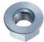
フランジ付ナットの座面圧力は、ネジ部直下に集中し、座面外周側まで働いていない。軸に対し非対称分布を示している。
